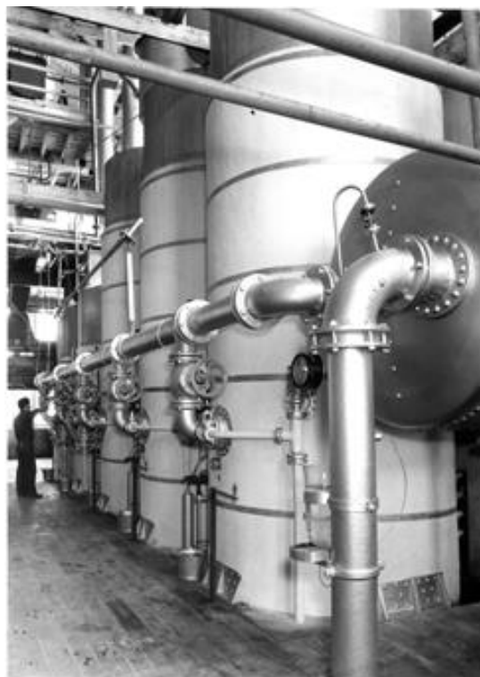
Figura 14 e Figura 15 – Tacho de cristalização a vácuo (esquerda) e aparelhos de saturação com reciclagem (direita).
